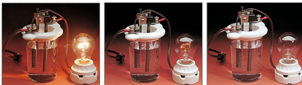
Рис. 23. Приборы для измерения электропроводности веществ
